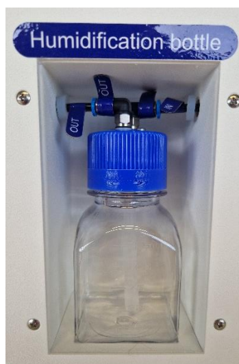
Figura 22.1 Ligação do tubo à garrafa de humidificação e à incubadora de FIV multicâmara Mini MIRI® Humidity
