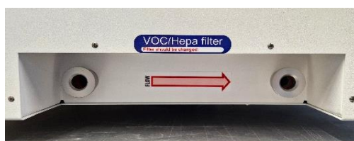
Figura 12.1 A seta do fluxo na incubadora de FIV multicâmara Mini MIRI® Dry
